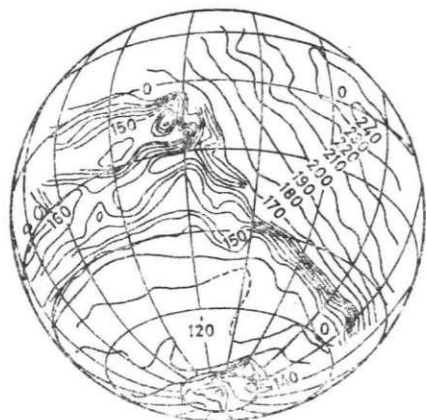
2. att. Marsa virsmas temperatūra (°K) 1976. gada 29. jūnijā pēc «Viking-1» infrasarkanā radiometra mērījumiem 18—24 μm kanālā. (Tā kā patiesībā Marsa iezī nav ideāli siltuma izstarotāji, faktiskā virsmas temperatūra ir dažus grādus augstāka par attēloto; skaitliski novērtēt šo starpību ļāva mērījumi trijos citos «Viking» radiometra kanālos 6—12,5 μm diapazonā.)
