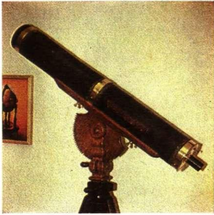
Pirmais Viļņas observatorijas instruments — koka refraktors, M Radvila dāvana. Stobra garums 106 cm, diametrs 14 cm, trijkāja augstums 153 cm. Anglija, 18. gs.
