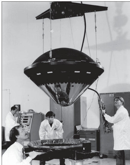
"Galileo" zonde ar grafīta kompozīta aeročaulu. NASA/JPL foto
