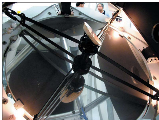
7. att. Stromlo kalna observatorija: 1,8 m teleskops kosmisko objektu lāzerlokācijai.
