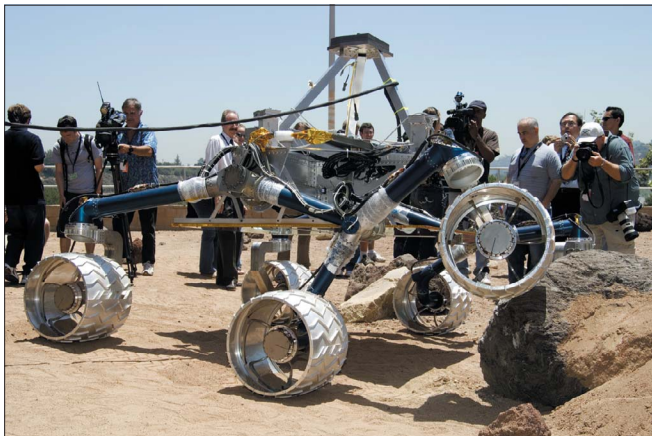
1. att. MSL robota prototipa fizisko spēju pārbaude uz imitētiem Marša akmeņiem 2007. gada jūlijā.
