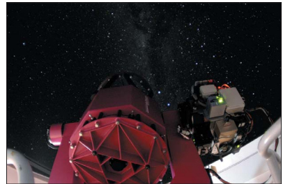
1. att. REM 60 cm diametra robotteleskops Lasijā. ESO PR Photo 26/a07
