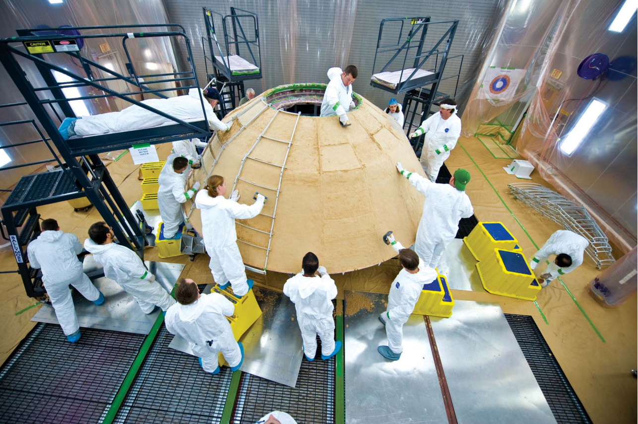
Milzīgās 4,5 metru diametra aeročaulas tapšana – rūpīgs roku darbs.
