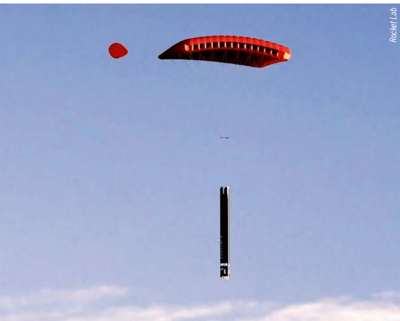
Electron raķetes pirmās pakāpes atgūšanas izmēģinājums
