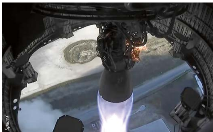
Skats no bloka iekšpuses pirmā lidojuma laikā. Redzama zilgana gāzu plūsma, kas liecina par to, ka dzinējā tiek sadedzināts metāns
