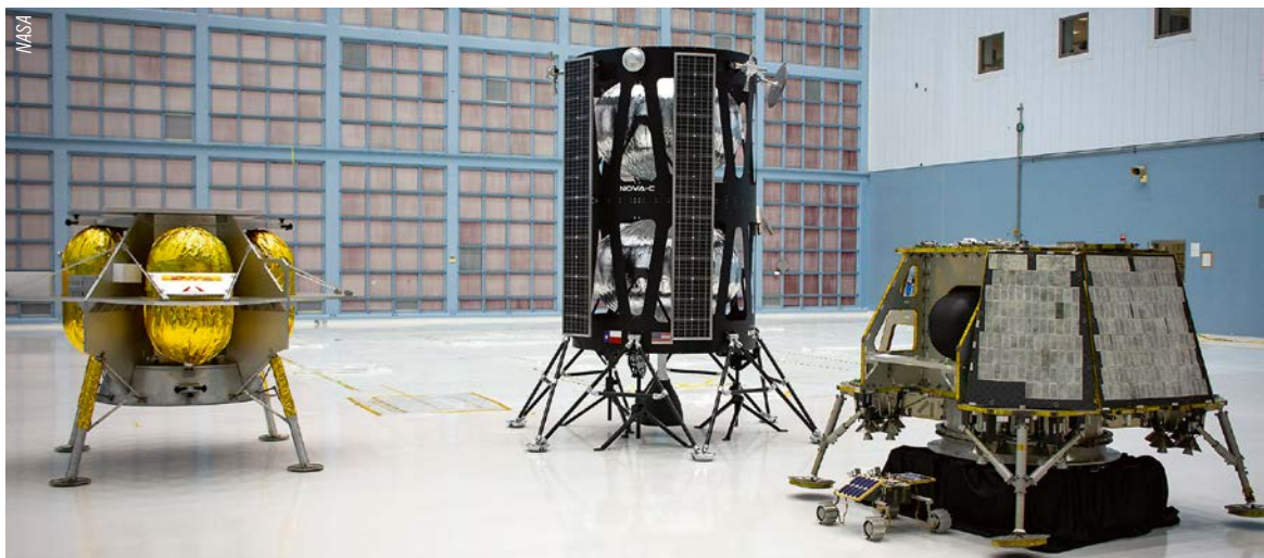
Pirmo trīs komerciālo Mēness misiju nolaišanās moduļi. No kreisās – Astrobotic Technology izstrādātais Peregrine , Intuitive Machines izstrādātais Nova-C un OrbitBeyond izstrādātais Z-01
