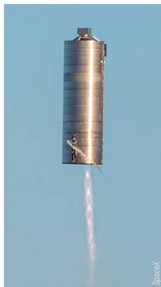
Starship SN5 lidojumā. Uzskatāmi redzams, ka dzinēja sprausla ir orientēta ieslīpi
