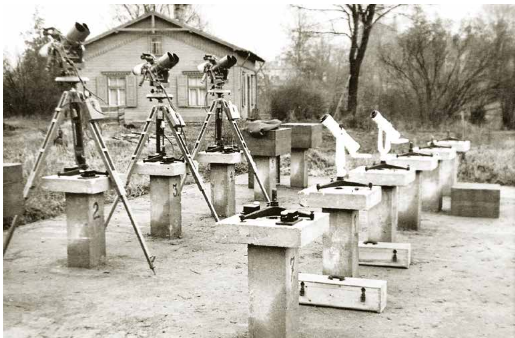
ZMP novērojumu platforma ar tālskatiem AT-1 un TZK
